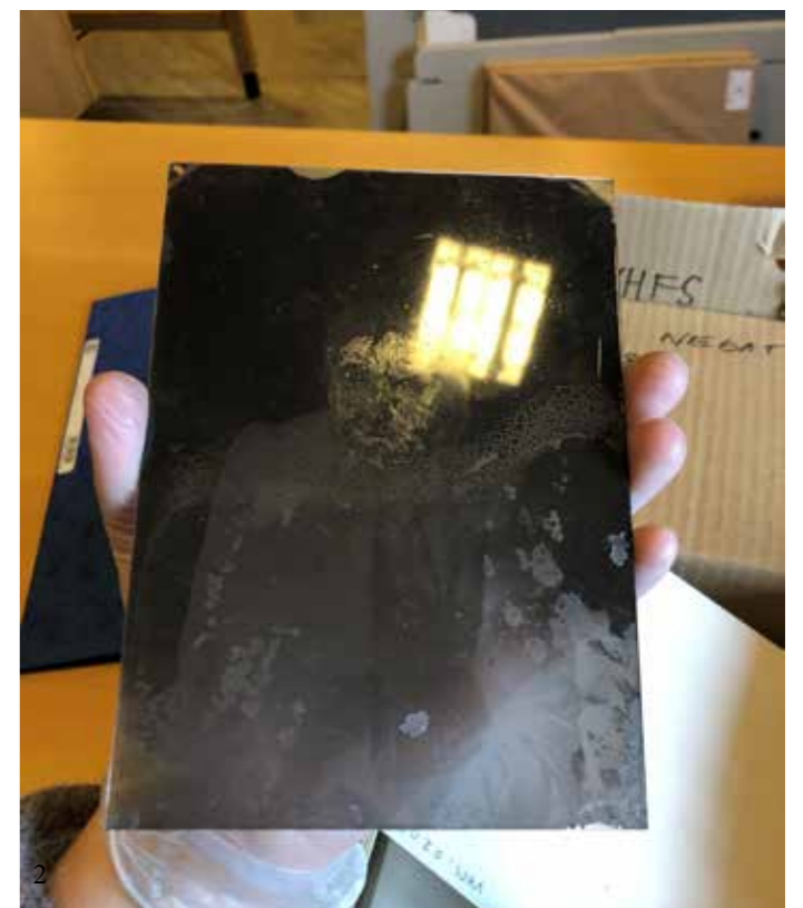
1. Skadet negativ med flekker fra Vardø museums samling. 2. Glassnegativ med krakelering fra Vardø museums samling.
