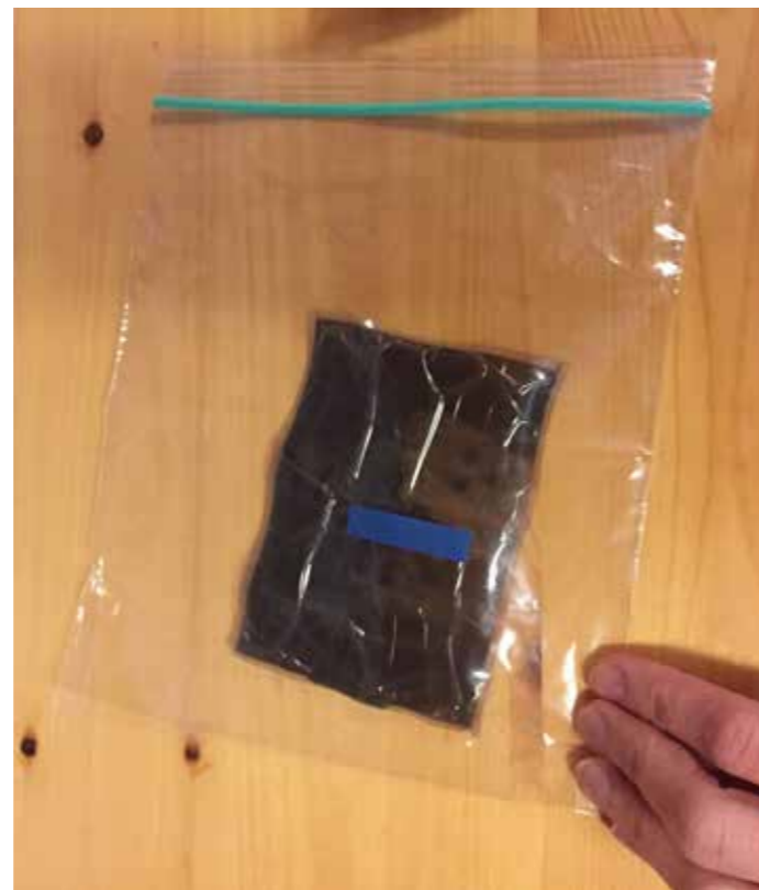
1. Resultat av A-D testing av Henry Hansen/Karl Hansen portrettarkiv (eldre). 2. Farge på teststripe før A-D testing av skadet negativ. Etter testing viste teststripen en lys grønn farge.
